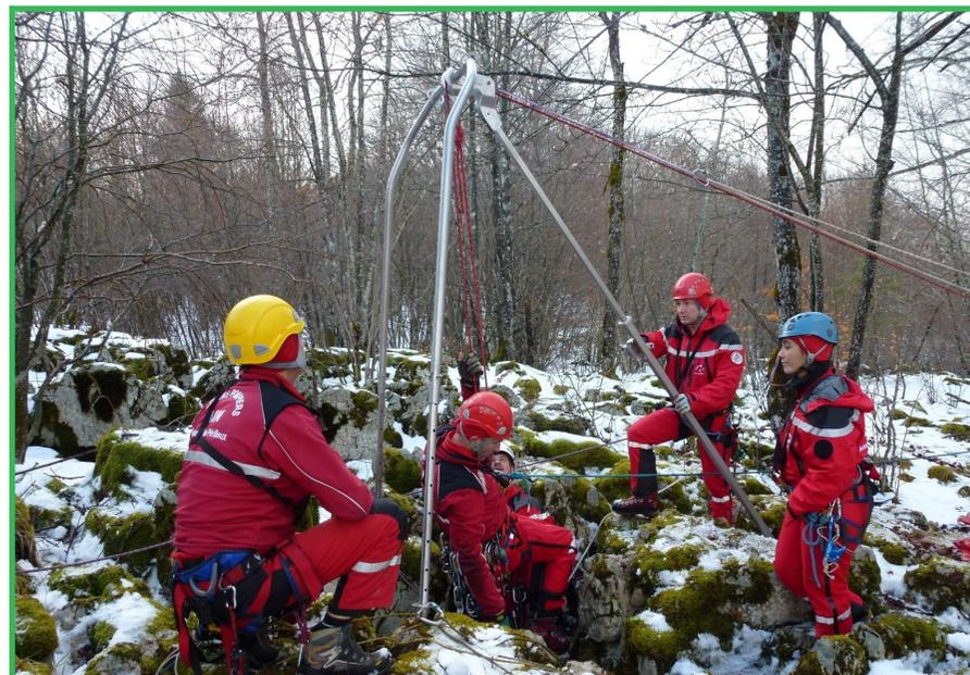
La mise en place doit respecter la notice (aubanage, platine,...). Elle peut être mise en mode trépied en retournant les pieds ce qui permet d'avoir les mêmes avantages mais pour une excavation. Elle peut également être utilisée pour les secours pour échapper des parapets, avoir un point en partie haute et positionner un treuil sur le pied arrière pour la remontée.
