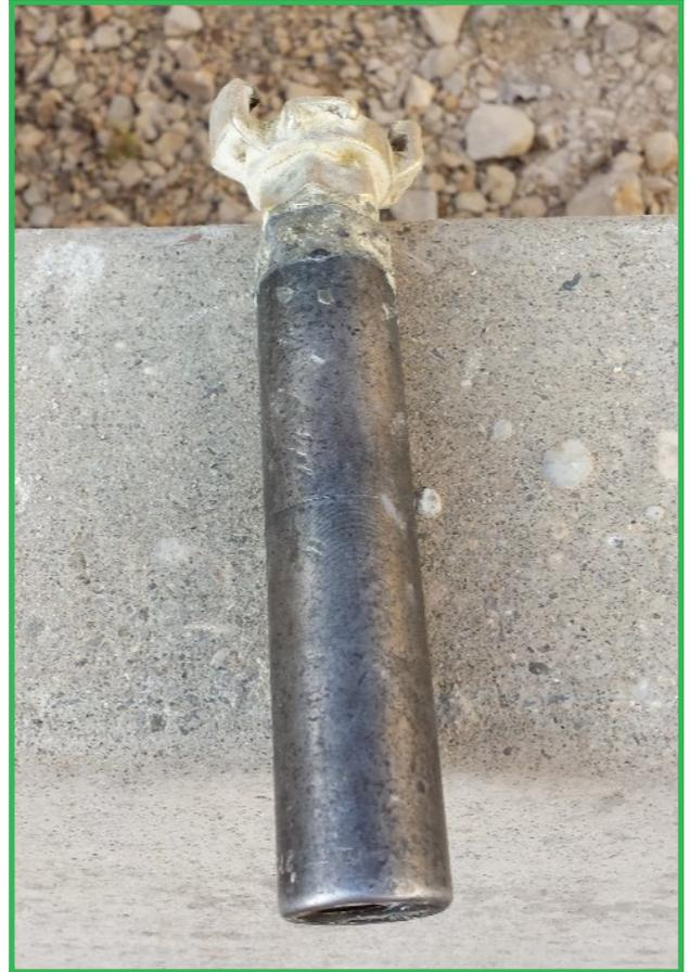
L'évacuation d'un cutting peut se faire avec un jet d'air ou d'eau sous pression (mieux). Pour l'air une petite adaptation (photo de droite) permet de faciliter le ramonage. L'utilisation d'un masque respiratoire est indispensable pour cette phase.
