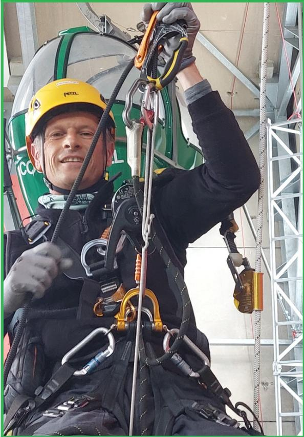
L'utilisation de connecteur avec une poulie réduit les efforts, il en existe à verrouillage vers le bas, vers le haut ou sans verrouillage en fonction de l'utilisation prévue.
